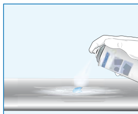
Opravené miesto ošetriť zinkovým sprejom
